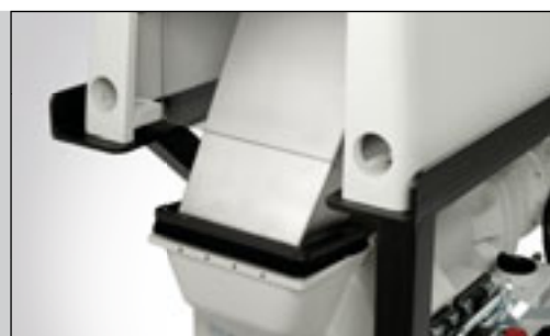
Соединительный лоток автоматически передает предварительно измельченный материал на тонкое измельчение.
